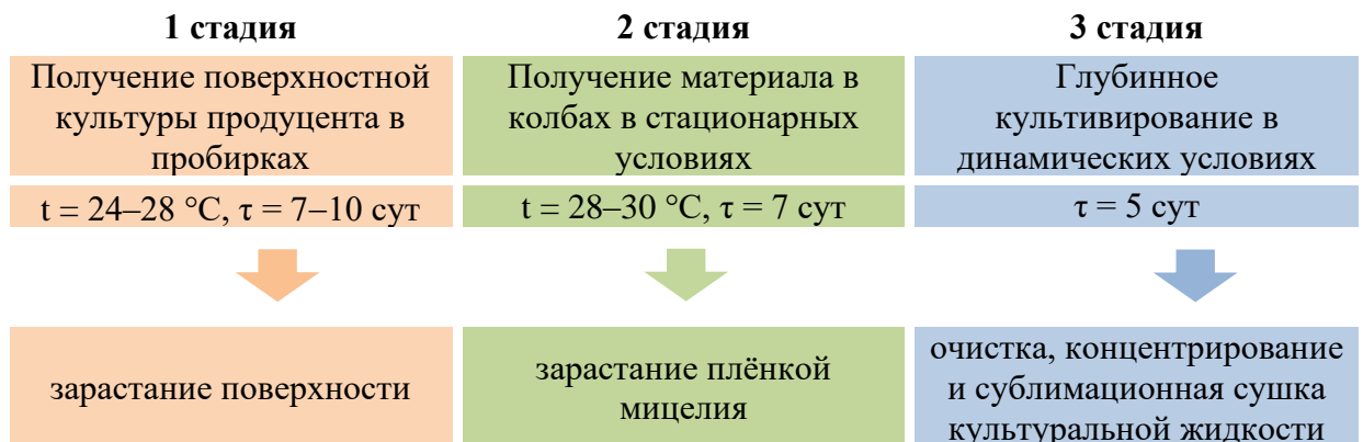
Рис. 2. Схема получения ферментного препарата из культуры базидиомицета
