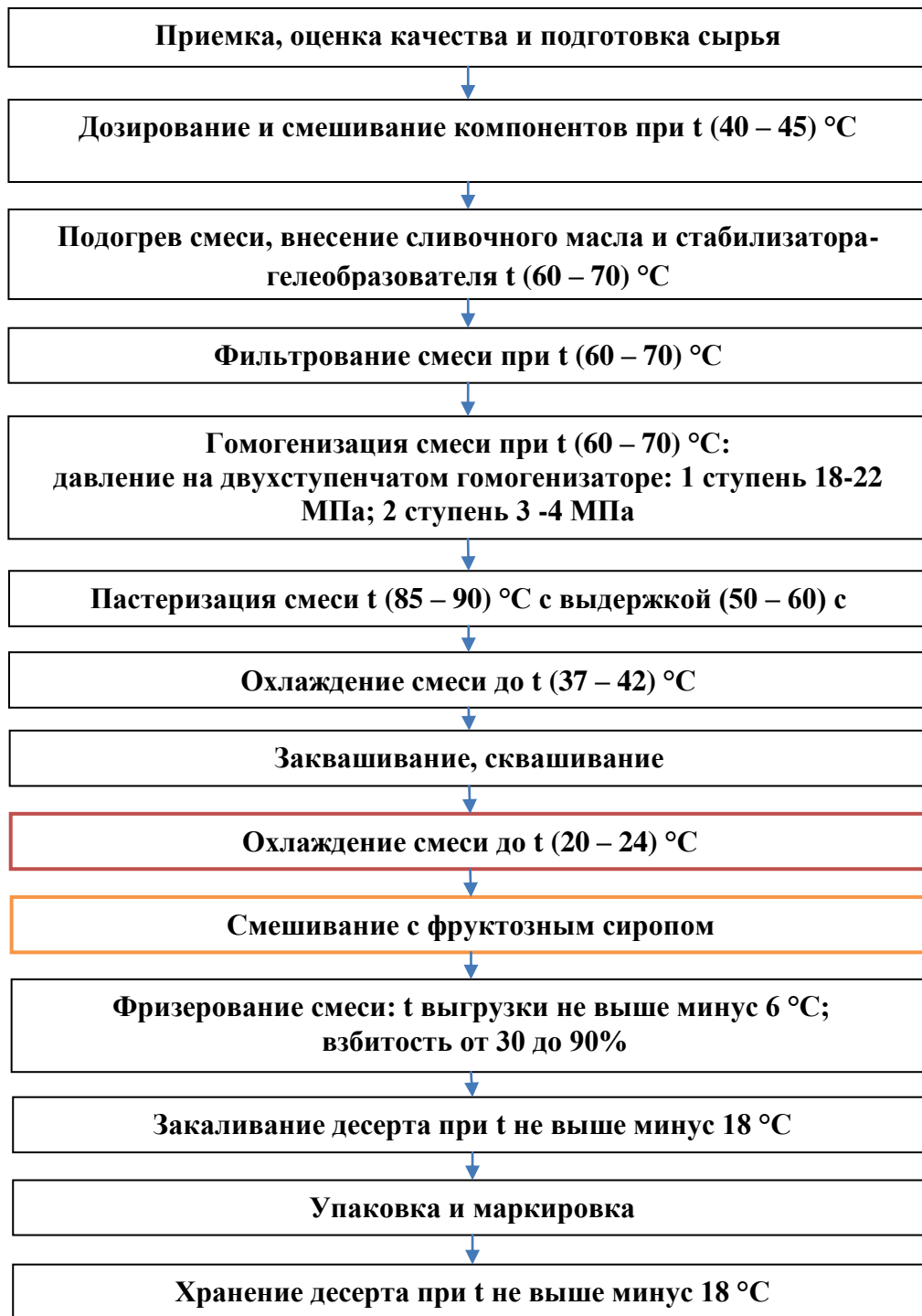
Рис. 3.30 Технологическая схема изготовления взбитых кисломолочных десертов с использованием заквасочных культур
